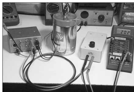
Versuchsaufbau mit abgeschirmter Diode (runde Blechdose in der Mitte)
